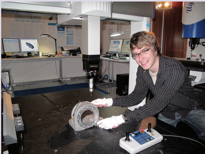
Routine für das Protokoll: Pascal Mohr aus Breuna bestückt die Koordinatenmessmaschine. Volumen und Maßhaltigkeit müssen kontrolliert werden, um die Korrekturintervalle für die Produktionsmaschinen prüfen zu können.
